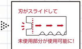
刃がスライドすることにより、ガードで隠れていた未使用部分の刃が露出して再度使用が可能になります!
