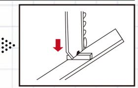
替刃の先端にあるスリットを 10 枚入替刃の箱に設けられたスライド用リブにあてがい押し付けます。
