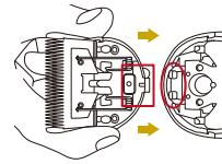
○図の刃下部の小さな突起部分を、本体背面側の□図に引っかけ、カチッと音がするまで刃先を押し込む(本体背面にある金属部は引っかける部分ではありません。)
