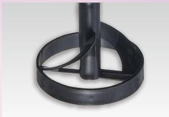
3Dブレードをらせん状にすることで、薬剤を下方へ押し出し立体的に攪拌。高速かつ効率的な攪拌が可能で、手混ぜに比べて大幅な時間短縮が図れます。
